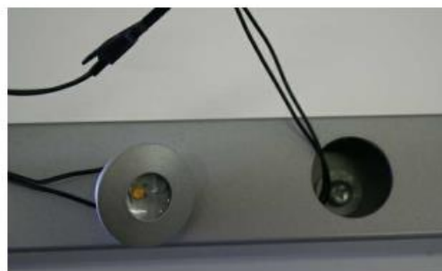
Abb.3 Ansicht verdeckte Montage (Schraube und Kunststoffscheibe hinter der LED)
